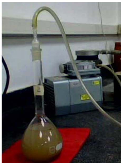
2. Conexión de la bomba de vacío.
