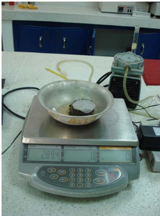
8. Pesaje de la muestra después del ensayo de permeabilidad..
