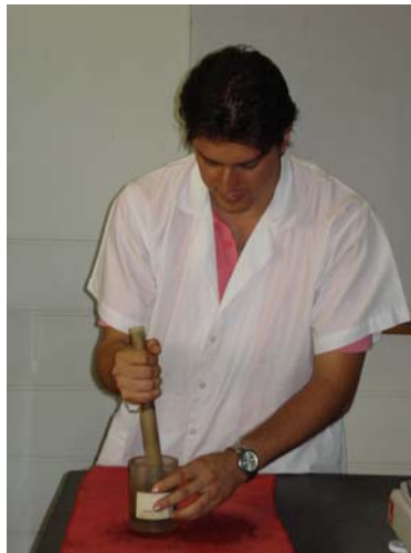
4. Compactación de la muestra para el ensayo de permeabilidad.
