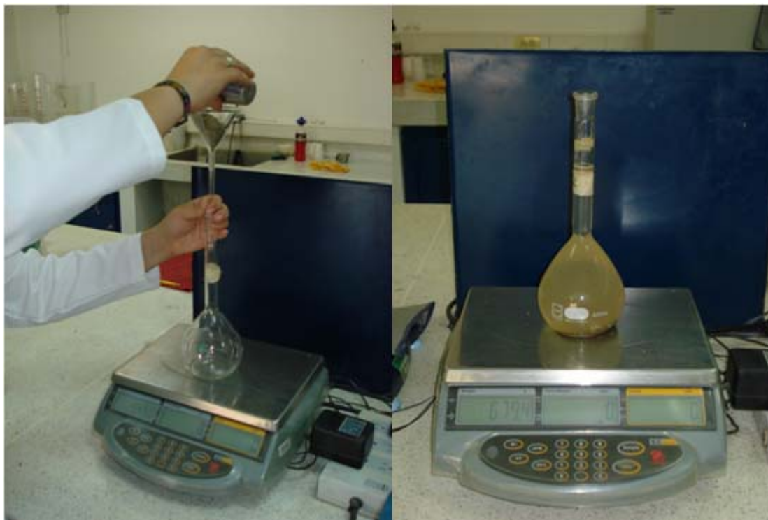
1. Adición de arena al matraz y registro del peso añadido.
