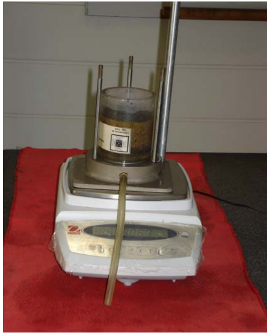
5. Pesaje de la muestra para el ensayo de permeabilidad.
