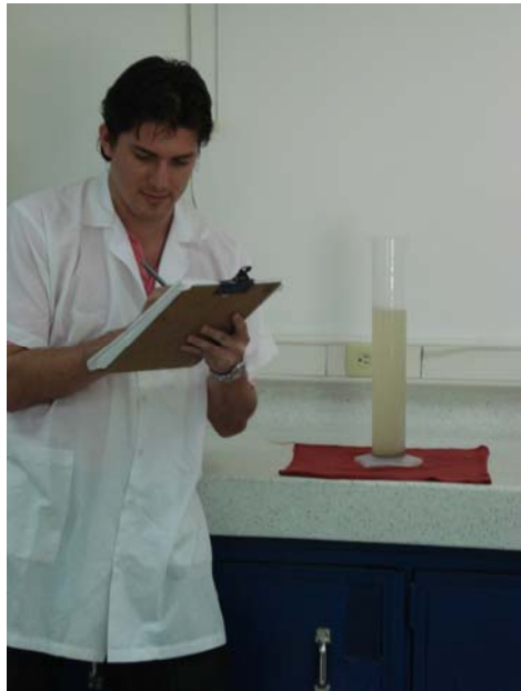
7. Registro del volumen obtenido en la probeta en el ensayo de permeabilidad
